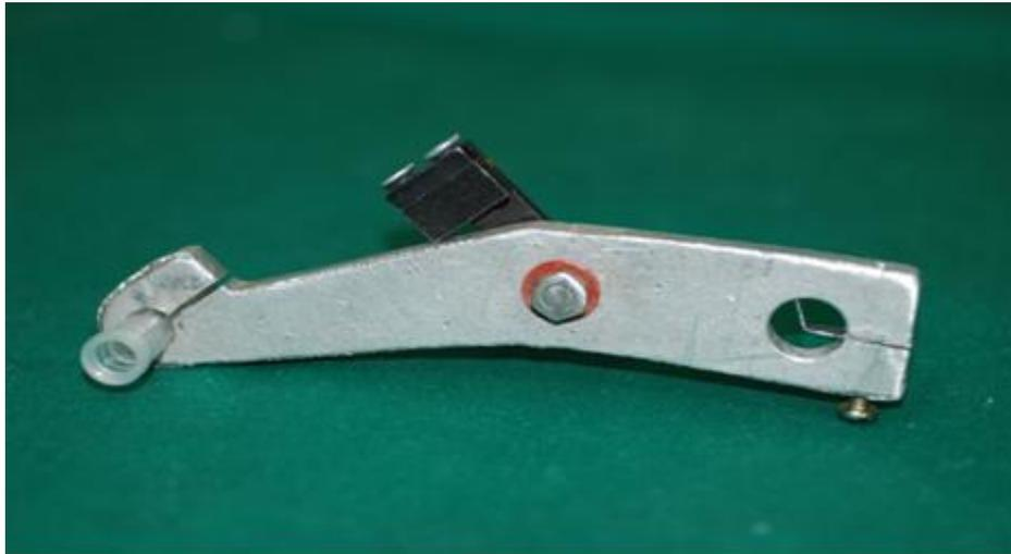
ภาพที่ 3 อุปกรณ์สำหรับตัดเข็มล้างท่อน้ำตาข้าง
